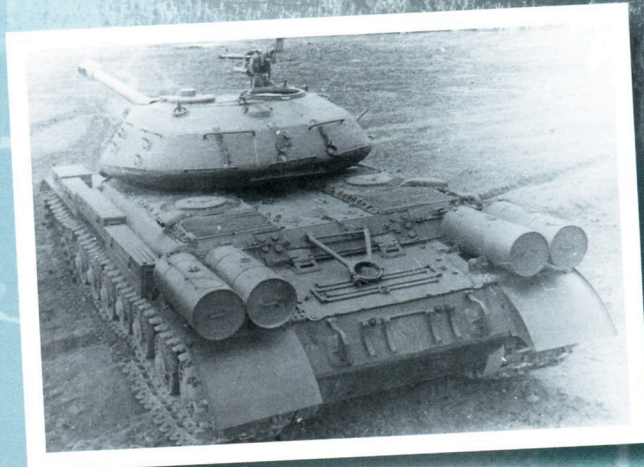
★ Танк ИС-4. Обращает на себя внимание характерное и необычное для советских танков расположение дополнительных топливных баков.
